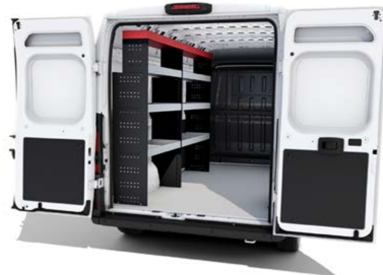
Laderaumboden Würth &amp; Regalsystem Würth – als Zubehör verfügbar (Einbau beim Händler)
